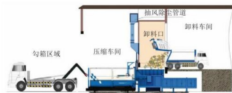
图 2-5 水平压缩转运站的示意图
